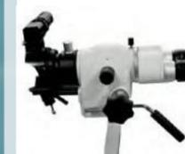
Микроманипулятор позволяет подключать хирургические лазерные системы и проводить прецизионные операции под контролем микроскопа
