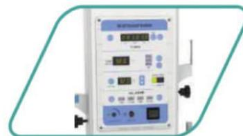
Температурный датчик и таймер обратного отсчета
